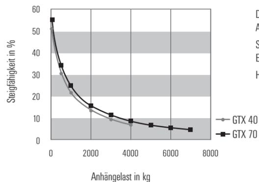
Das Steigfähigkeitsdiagramm zeigt die Kombination aus Anhängelast und Steigung.
